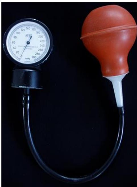
Figura 5 – Equipamento utilizado para controle da pressão externa exercida sobre a superfície ventral da traqueia cervical, durante a realização da técnica compressiva.
