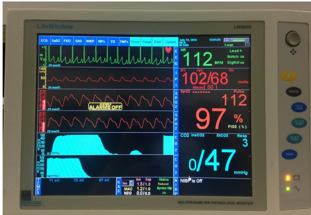
Figura 3: Monitor multiparamétrico veterinário com leitura dos parâmetros de FC, PAS, PAD, PAM, f, SpO2, PETCO 2 , EtIso e CAM.
