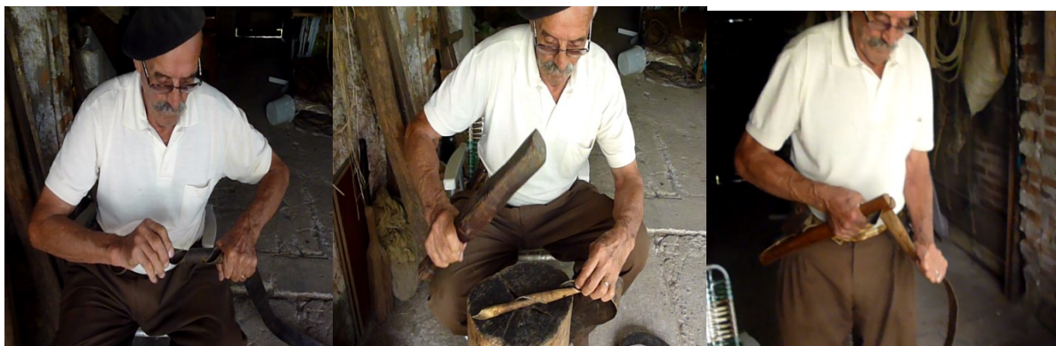
FIGURA 11 a 13. Nas imagens abaixo, na fig.11 o guasqueiro está torcendo o couro para sovar do lado interno, já na fig.12 o guasqueiro está sovando e na fig.13 o mesmo está passando a mordança para amaciar o couro.
