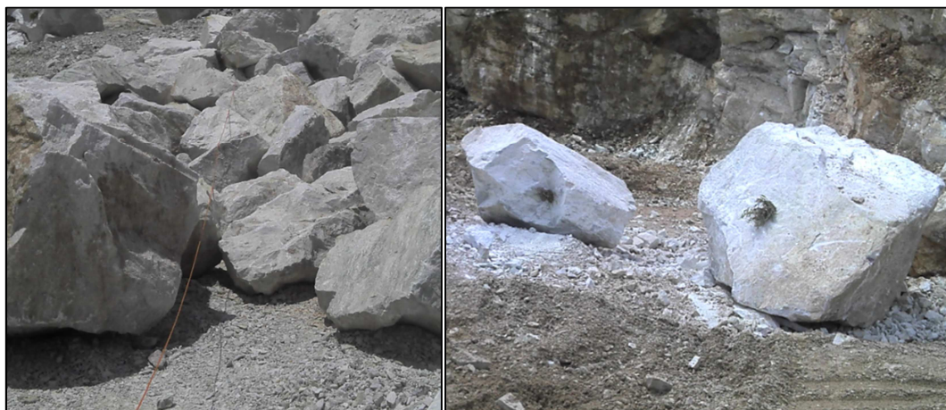
Figura 13: Cordel exposto (à esquerda) e matacões marcados para desmonte secundário com os respectivos tampões.
