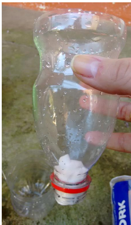
Figura 9 a e b - Corte do filtro, colocação do algodão e camadas filtrantes.
