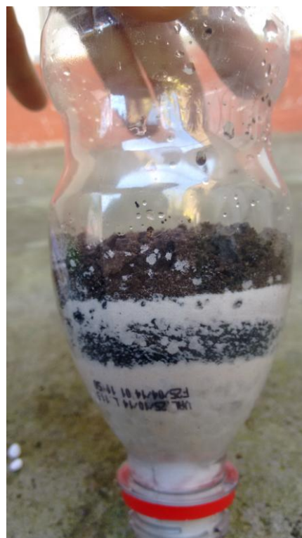
Figura 9 a e b - Corte do filtro, colocação do algodão e camadas filtrantes.
