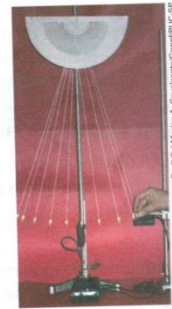
FIGURA 7.3. Fotografia de exposição múltipla de um pêndulo simples em oscilação.
