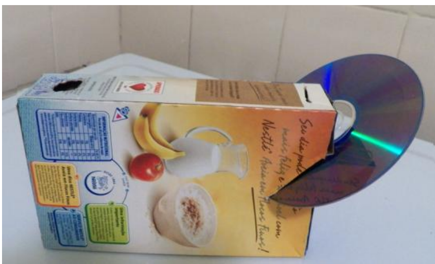
Figura 13: Dispositivo construído pelos alunos para demonstrar a decomposição da luz
