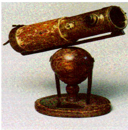
Figura 31: Mostra o telescópio refletor construído por Isaac Newton. (Retirada de http://astro.if.ufrgs.br/bib/newton.htm ).
