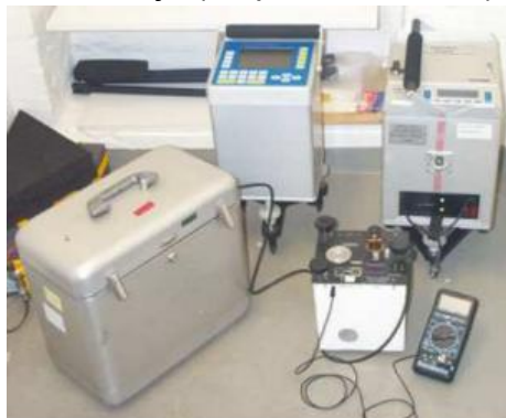
Figura 62. Três gravímetros relativos: Scintrex Autograv CG-3 (em cima, à direita), Scintrex Autograv CG-5 (em cima à esquerda) e LaCoste–Romberg modelo G, com seu estojo (na parte da frente)
