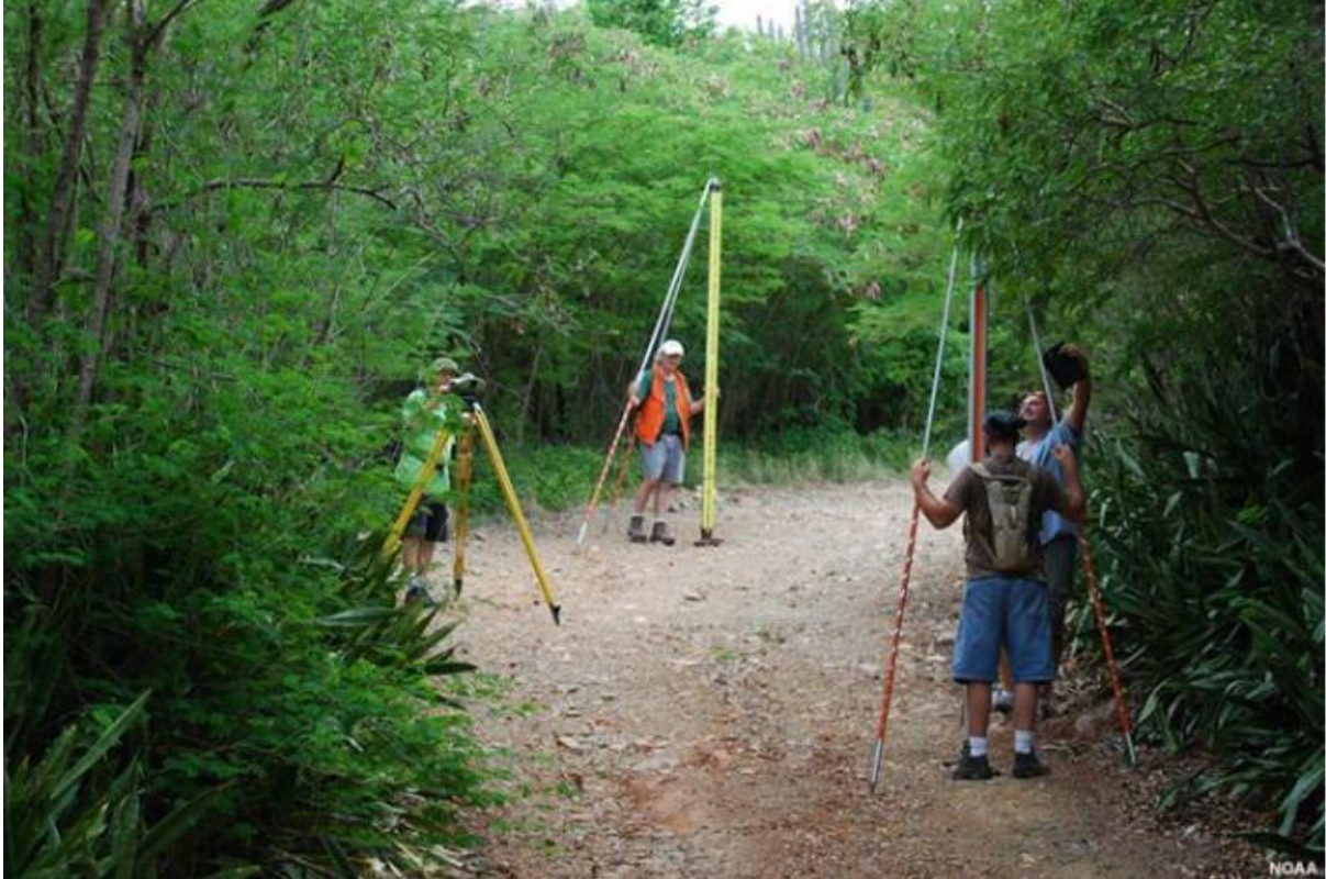
Figura 29. Nivelamento geométrico (de precisão) na prática
