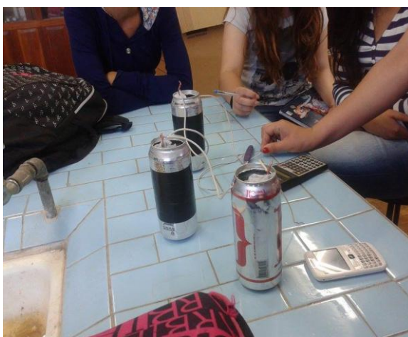
Figura 1: Foto da montagem da pilha fabricada pelos alunos. Fonte: os autores.
